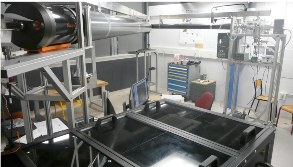
Image 4 : Dispositif de spectroscopie Raman résolu en temps de l'IMPMC permettant de faire des expériences en chambre martienne (à droite de l'image) grâce à l'analyse à distance avec un télescope (en haut à gauche) © IMPMC
