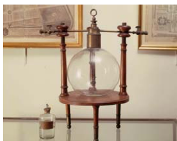
Appareil de Lavoisier employé par Fourcroy et Vauquelin pour la synthèse de l'eau (1790) © Bibliothèque centrale / MNHN
